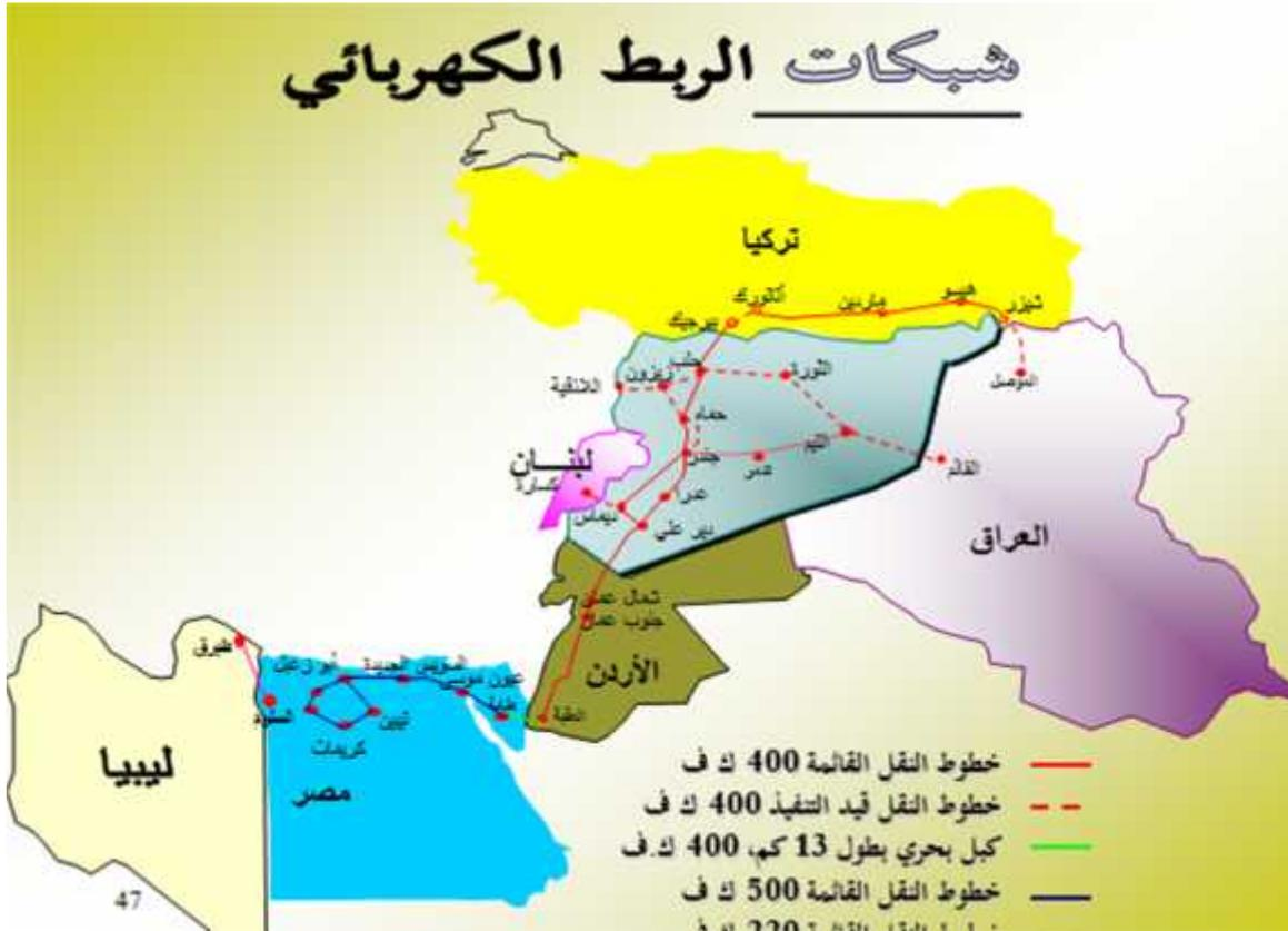
الشكل (5-9) شبكات الربط الكهربائي في سورية - المصدر وزارة الكهرباء [41]
